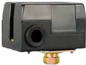
interruptores de presión- Presostatos APSW2F Interrupción de presión con 1/4" conexión hembra 1.4-2.8 bar (20/40 psi) APSW3F Interrupción de presión con 1/4" conexión hembra 2.1-3.4 bar (30/50 psi)
