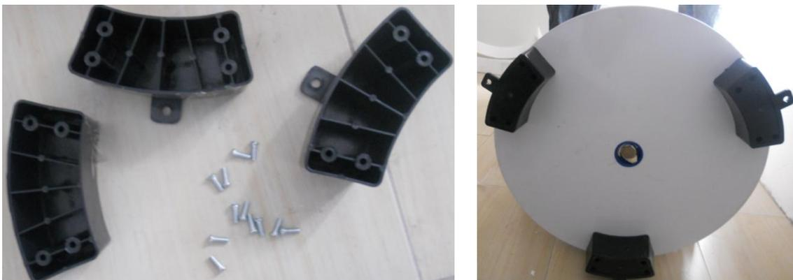
Figura 5: Fijación de los soportes a la base del reservorio
